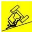
Během používání nájezdů k nakládání či skládání vozidla může v důsledku chybného manévrů obsluhy dojít k převrácení nakládaného vozidla. Během nakládání a skládání není povolena přítomnost třetí osoby v blízkosti nájezdů.
